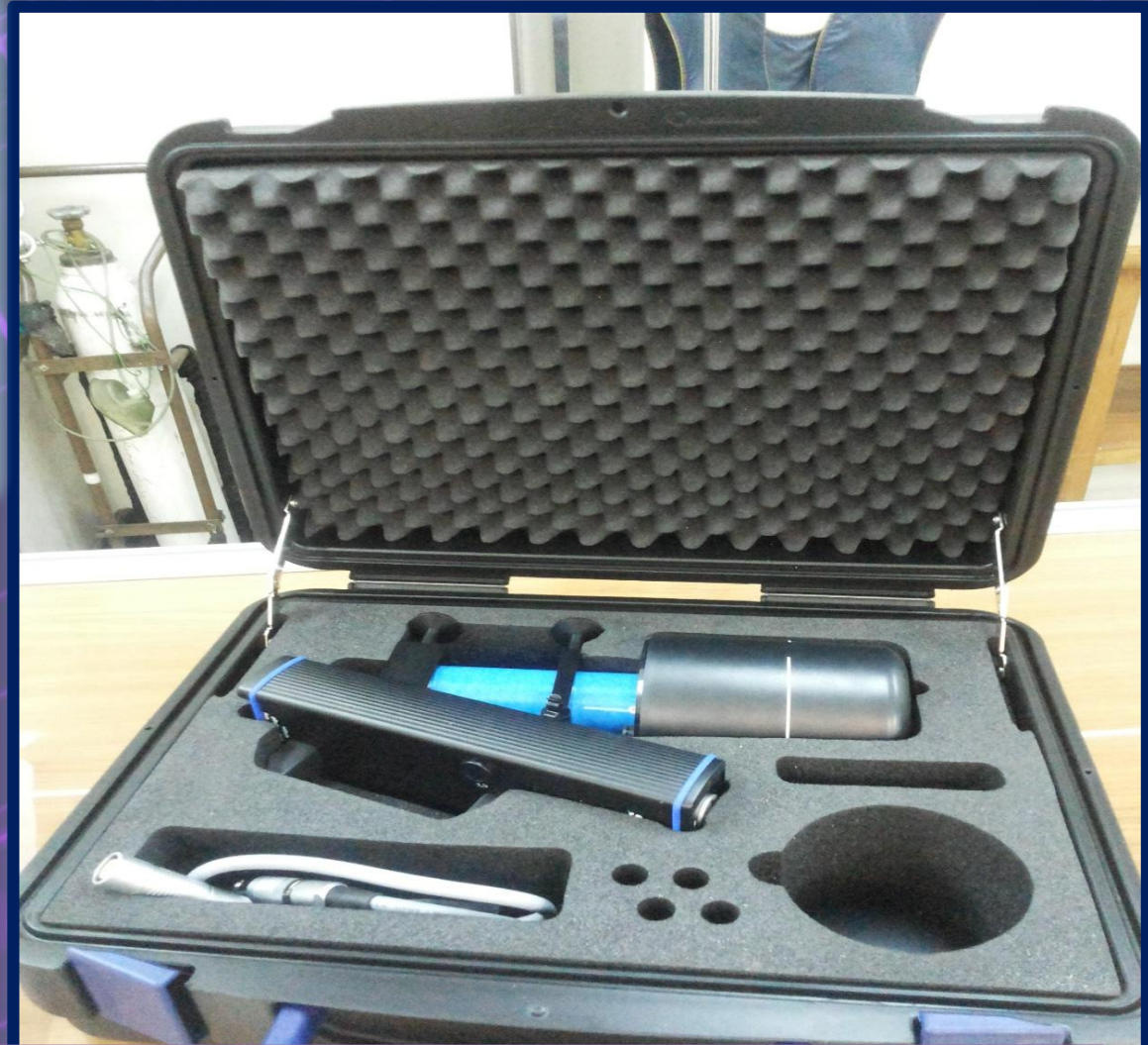
دزیمتر محیطی جهت اندازه گیری پرتوهای \alpha , \gamma , X ساخت کمپانی PTW آلمان
