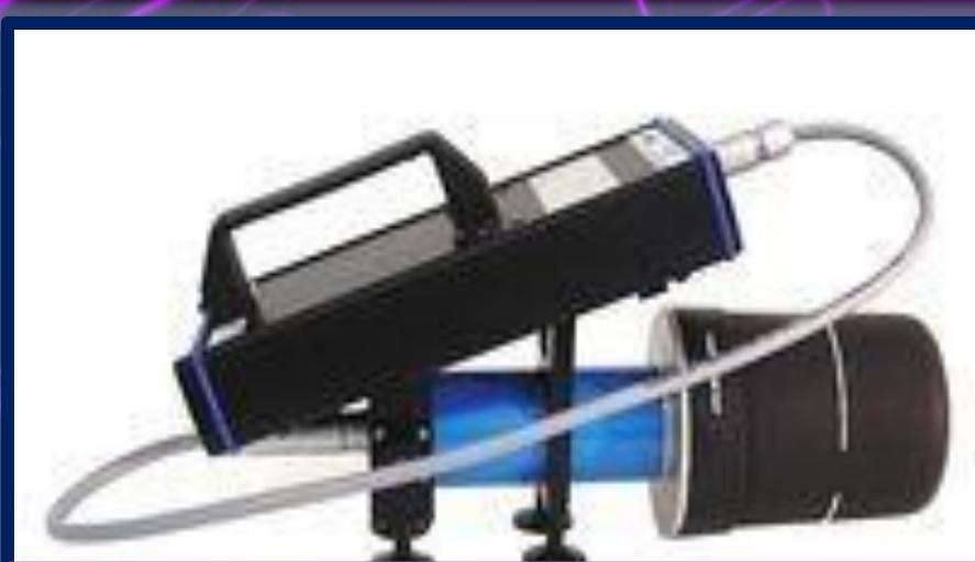
دزیمتر محیطی جهت اندازه گیری پرتوهای \alpha , \gamma , X ساخت کمپانی PTW آلمان
