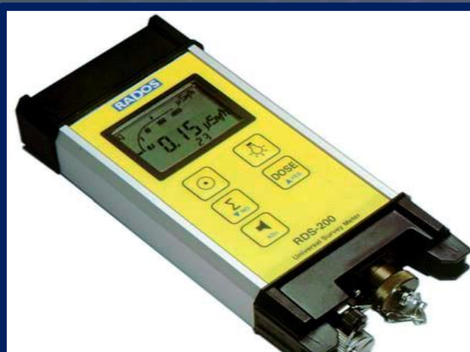
دزیمتر محیطی RDS-200 جهت اندازه گیری پرتوهای X, y
